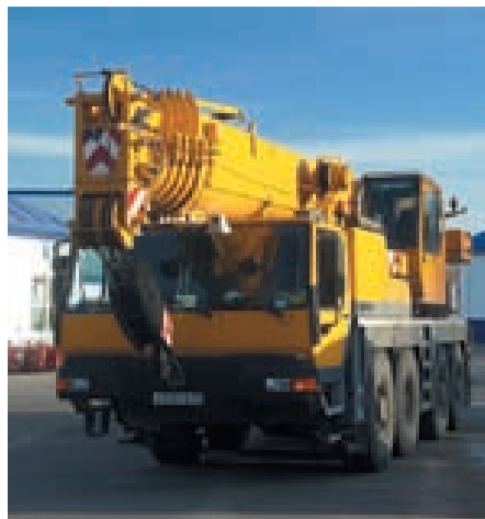
Автокран «Либхер» большой грузоподъёмности, способен поднимать груз массой до 80 тонн
